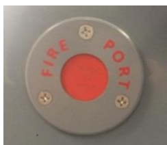
Feuerlöschöffnung auf der Backbordseite der Konsole
